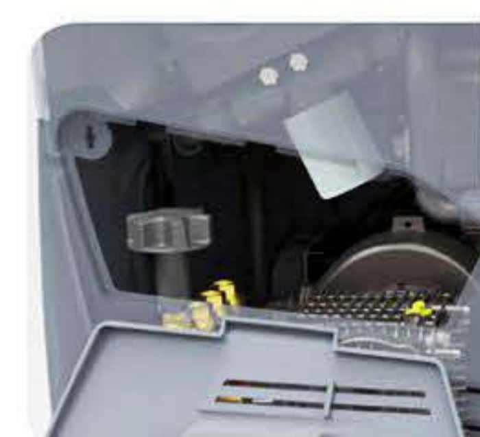
pannello ispezione pressione pompa e pulizia filtro acqua
